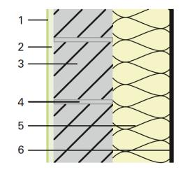
1-Peinture extérieure ; 2-enduit extérieur à base de mortier de ciment ;
